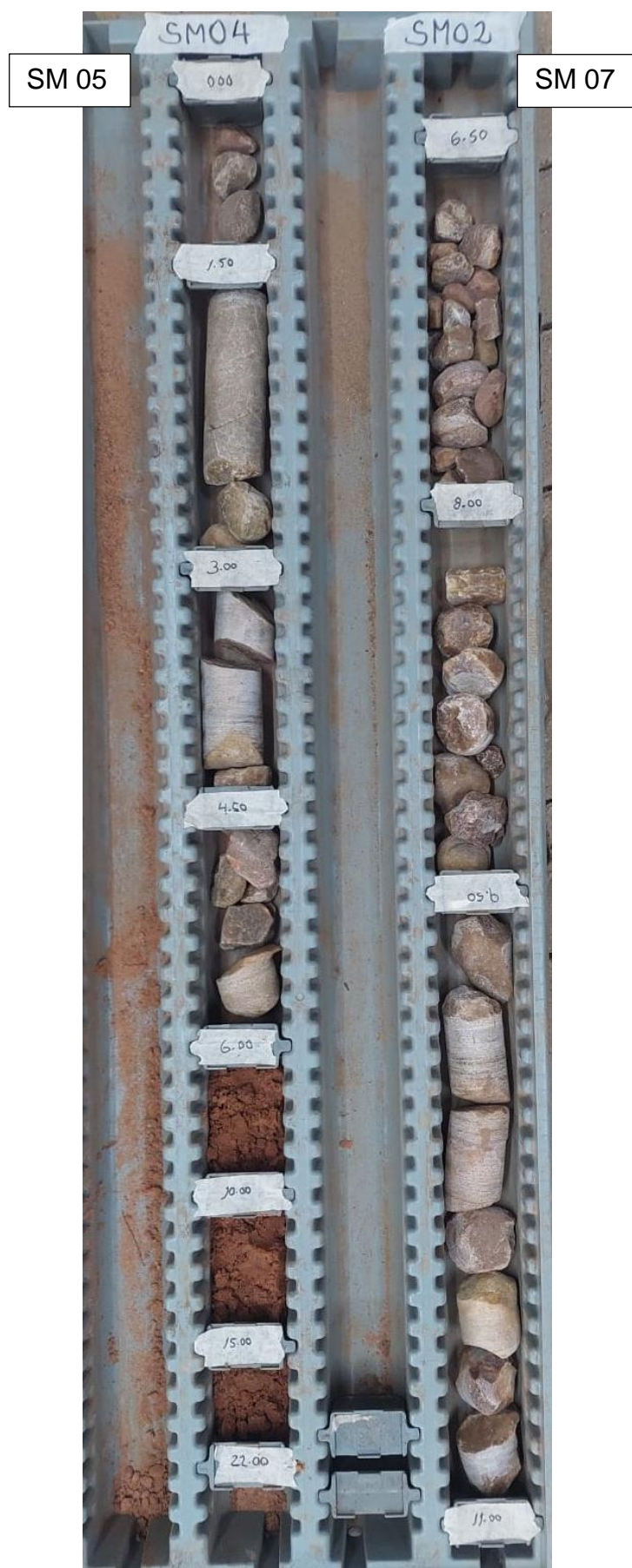
Foto 02 - Caixa com a sondagem SM07 e SM05, nomeada como SM02 e SM04 pela equipe de campo.
