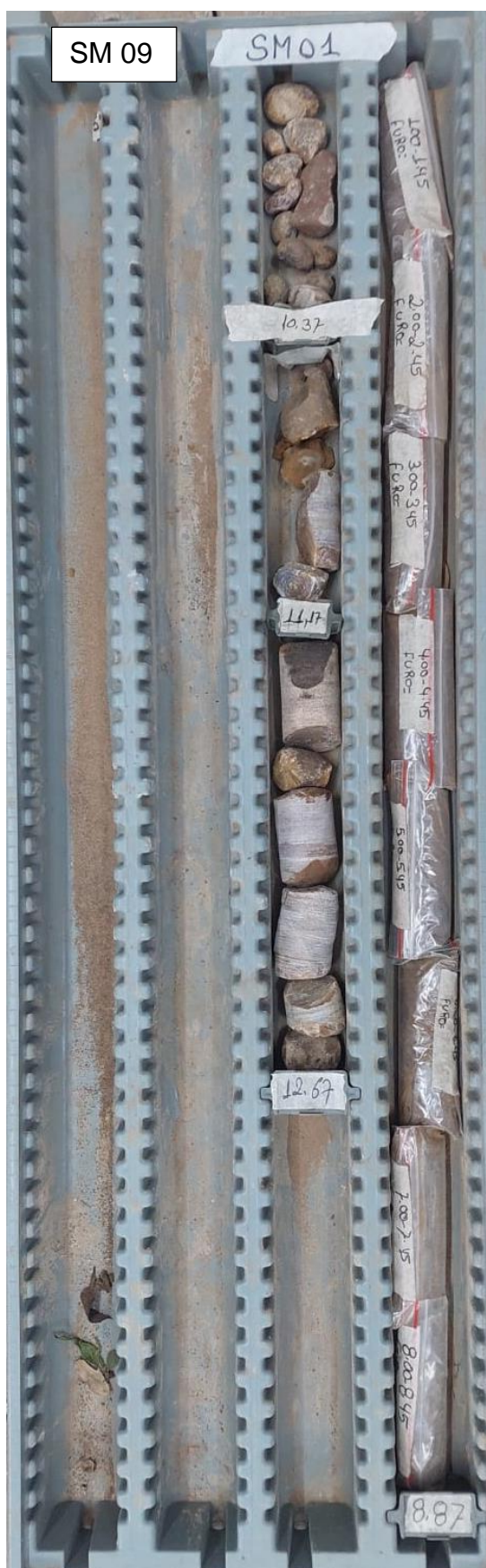
Foto 01 – Caixa com a sondagem SM09, nomeada como SM01 pela equipe de campo.
